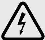
此符号显示设备内部非绝缘活动零件可能产生的触电危险。
